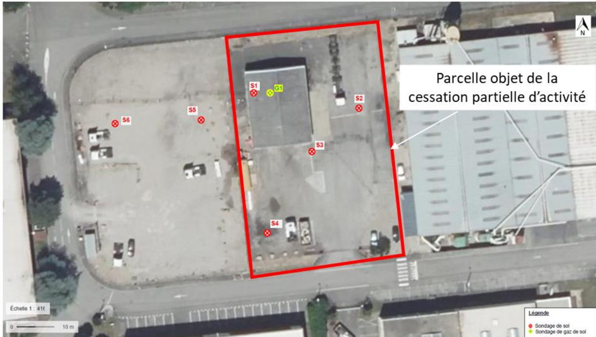
Figure 4 : Plan d'implantation des sondages réalisés (sol et gaz de sol) (source : G ENVIRONNEMENT, annotations GINGER BURGEAP)
